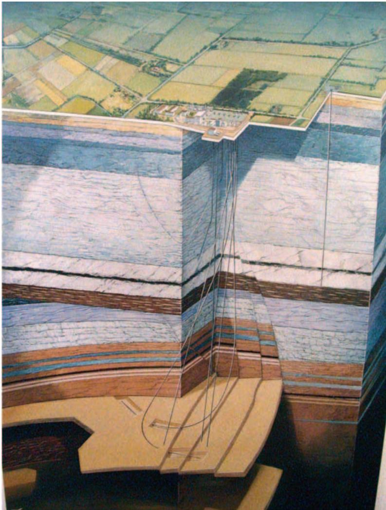
*Abb. 2: Schematisches Tiefenprofil einer Erdöl- oder Erdgaslagerstätte*
