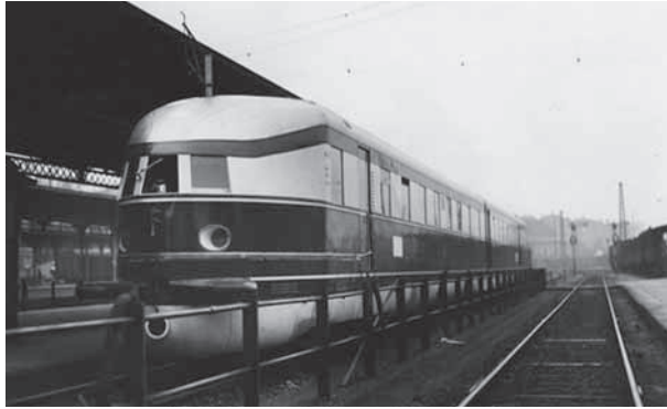
Abb. 9: Der Schelltriebwagen „Fliegender Hamburger“ auf einer Versuchsfahrt in Ulm, 1932 Rolls-Royce Power Systems AG, Friedrichshafen
