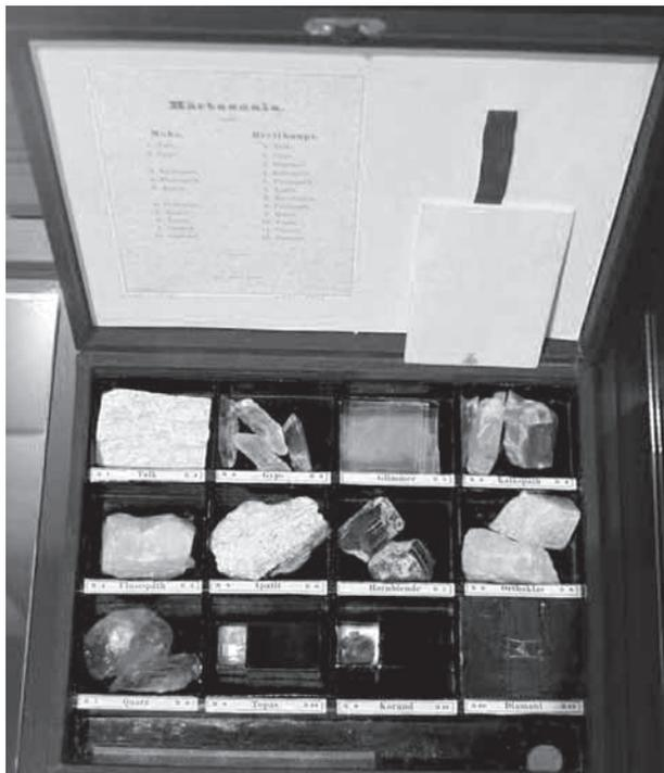
Abb. 12: Vergleichskasten zur Härtebestimmung von Mineralien
