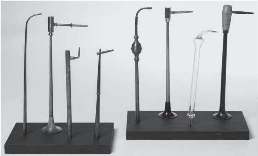
*Abb. 2: Lötrohre des 18. und 19. Jahrhunderts in verschiedenen Ausführungen
