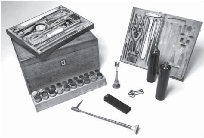
**Abb. 5:** kompletter „Lötrohrkasten“ nach Plattner, hergestellt durch die Firma Lingke (um 1850). Zu erkennen sind die bruchsicheren Brenner, ein Holzkohlestück und die platzsparende Unterbringung der Chemikaliensammlung
