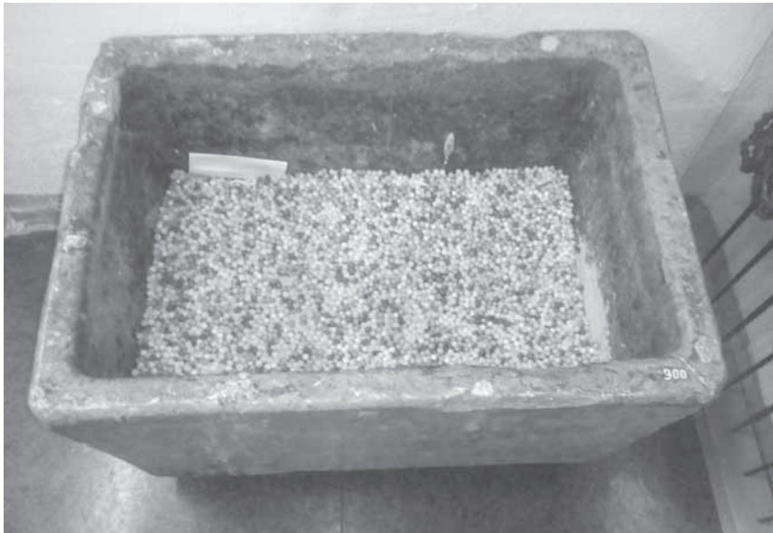
Abb. 5: Trogförmiger Hafen für die Schmelze von Glasknöpfen oder -perlen, fotografiert im Fichtelgebirgs-Glasmuseum Warmensteinach von Dagmar Hülsenberg
