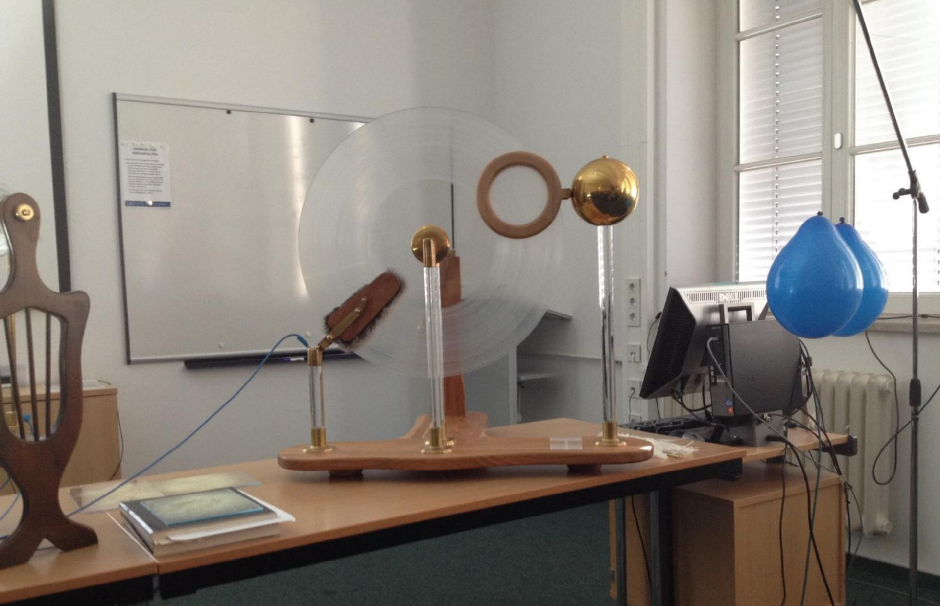
Die von Frau Send nachgebaute Elektrisiermaschine nach LeRoy wurde von Lichtenberg in seinen Vorlesungen zur Elektrizitätslehre verwendet. Das Original steht in der Sammlung "Physicalisches Cabinet" der Universität Göttingen und stammt vermutlich von 1772.
